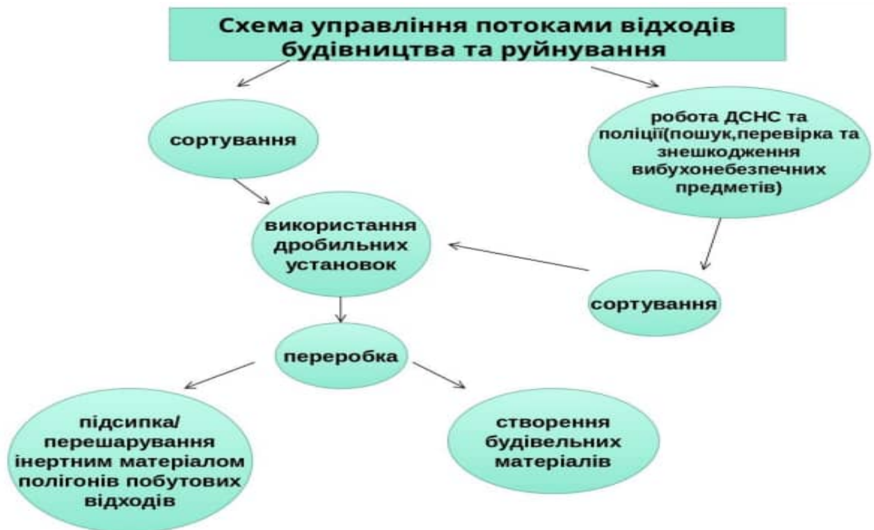
Рисунок 3.2.4. Управління потоками відходів будівництва та руйнування
